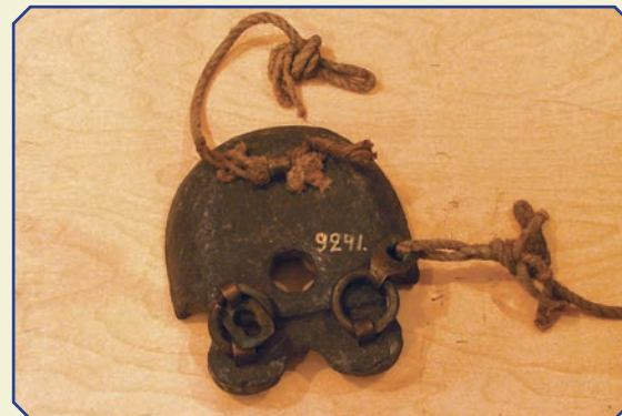
30. Груз плечевой, задний, с пеньковым брасом двенадцатиболтового, вентилируемого водолазного снаряжения системы Зибге-Гормана
