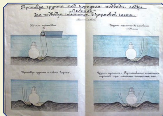
109. Промывка грунта под корпусом подводн. лодки «ПЕЛИКАН» для подведения полотенец в кормовой части. Масштаб 1:100
