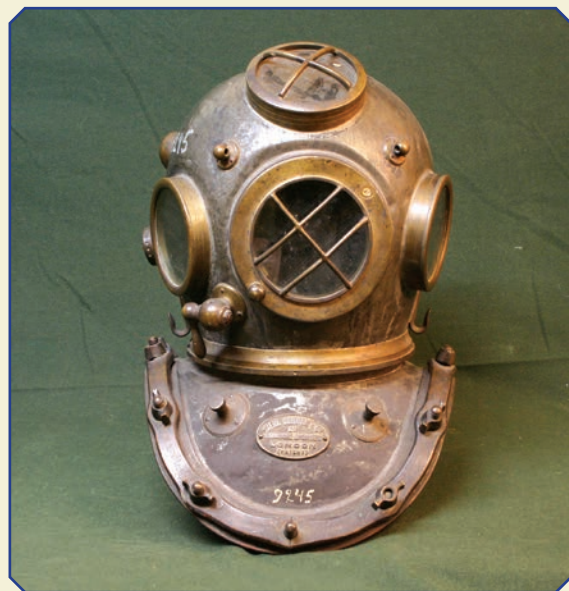
36. Шлем двенадцатиболтового, вентилируемого водолазного снаряжения SIEBE GORMAN & Co Ltd SUBMARINE ENGINEERS. LONDON (PATENT), зав.№ 6547
