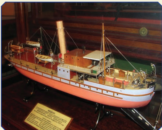
59. Модель строительная землесоса-рефулера для Ревельского порта, 1914 г.
