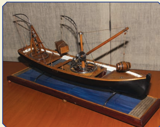
81. Гребной катер с тремя поворотными кранами для подъема водолазов и грузов системы Петрова.
