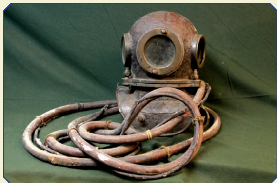
94. Шлем трехболтового, вентилируемого водолазного снаряжения образца ЭПРОН 1930 г. с воздушным шлангом и телефонным кабелем. СЕВЕРНЫЕ МАСТЕРСКИЕ ЭПРОН: котелок, зав.№ 474, манишка, зав.№ 742
