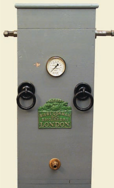
37. Помпа водолазная, ручная, одноцилиндровая, двойного действия, в футляре SIEBE GORMAN & CO ENGINEERS. LONDON, зав.№ 1920
