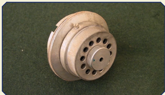
147. Травяще-предохранительный клапан для водолазной рубахи ПВ-059, универсальный. СССР, 1960-е гг. Металл, резина, 6,8 x 6,8 x 5 см КП № 44276/24
