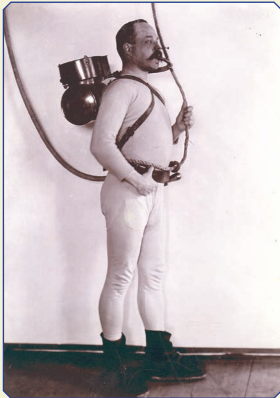
92. Аппарат Данеруза с регулятором Фотография конца XIX в. КП № ФГ-0-31476
