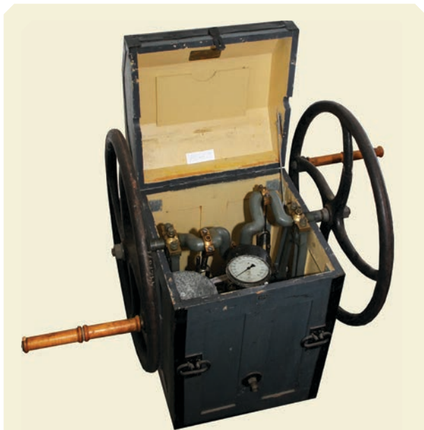
142. Помпа водолазная, трехцилиндровая, ручная, простого действия системы Данеруза в футляре
