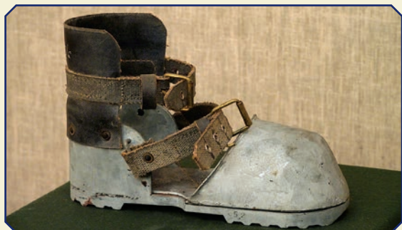
155. Галоши водолазные раздвижные Металл, прорез.ткань, винилпласт 36,3 x 12,2 x 19 см КП № 44275/6-7
