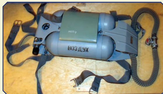
156. Воздушно-баллонный аппарат АВМ-3, зав. № 103 Металл, резина, прорезиненная ткань, пенопласт, 64 x 34 x 24 см КП № 44275/2
