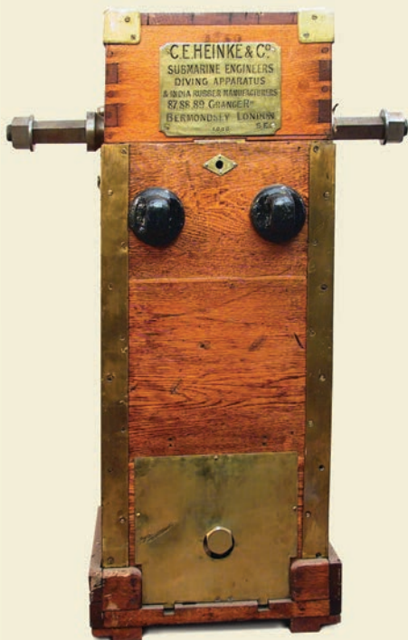
29. Помпа ручная, двухцилиндровая, простого действия, в футляре С. Е. HEINKE & CO SUBMARINE ENGINEERS DIVING APPARATS & INDIA RUBBER MANUFACTUERS. LONDON, зав.№ 1030
