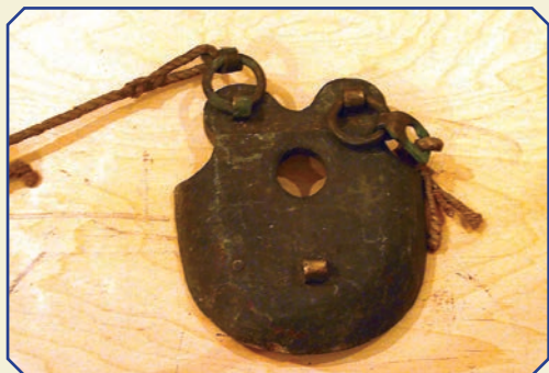
28. Груз плечевой, передний, с пеньковым брасом двенадцатиболтового, вентилируемого водолазного снаряжения системы Зибге-Гормана
