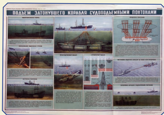
174. Подъем затонувшего корабля судоподъемными понтонами Плакат художника Ю.Ф. Кашкина, 1974 г. Бумага, печать, 81x56,5 см КП № В-20871
